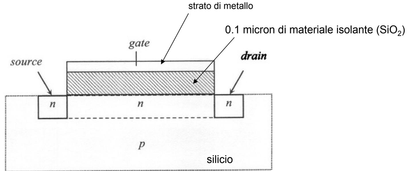
schema di un transistor ad effetto di campo
