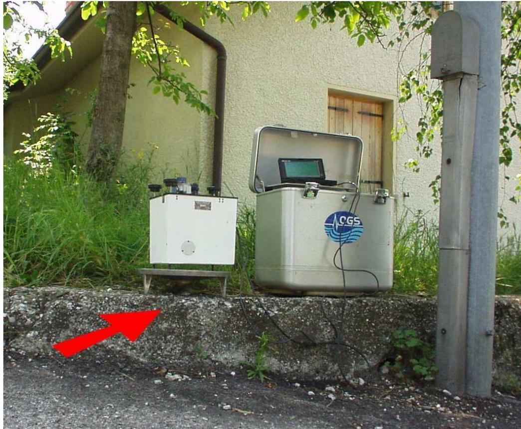
**Misura gravimetrica del punto 201. Si può vedere tutto l'apparato sperimentale: il piatto-treppiede, il gravimetro, il contenitore con dentro il computer tascabile. La freccia indica la borchia IGM.**
