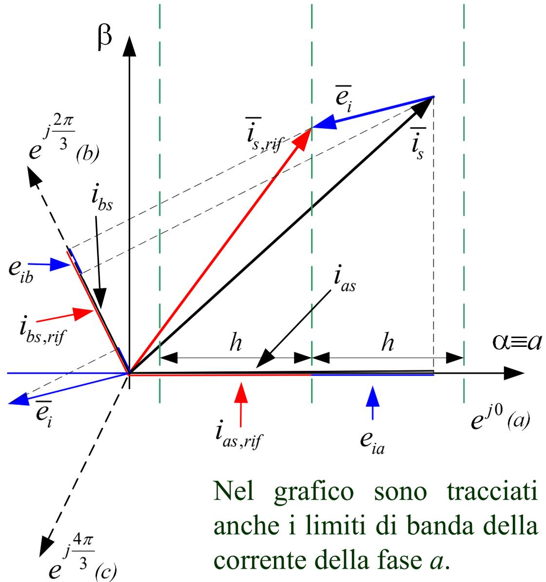
Nel grafico sono tracciati anche i limiti di banda della corrente della fase  $a$ .
