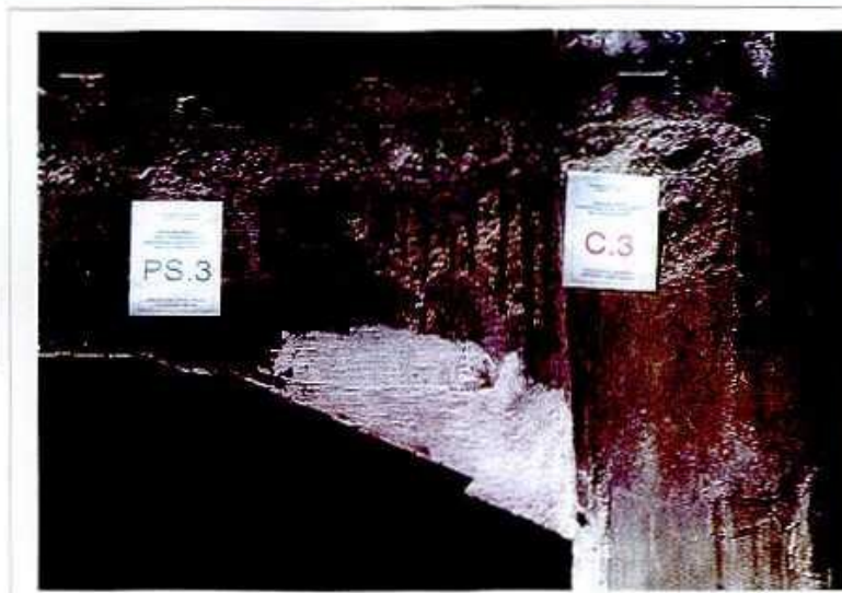
Foto 6: area di indagine 3. Esecuzione di: PS.3 - prove sclerometriche, PC.3 - prove di carbonatazione, P.3 - prelievo di campioni di cls copriferro per analisi chimiche
