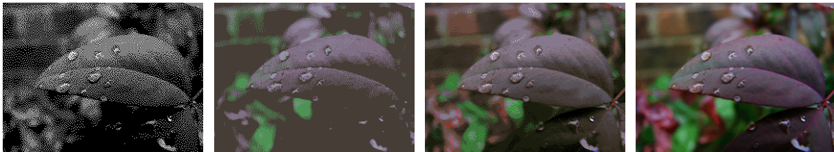
(a) Immagine monocromatica con 2 livelli di colore, bianco e nero (1-bit image) (b) Immagine con 4 livelli di colore (2-bit image) (c) Immagine con 16 livelli di colore (4-bit image) (d) Immagine con 256 livelli di colore (8-bit image)
