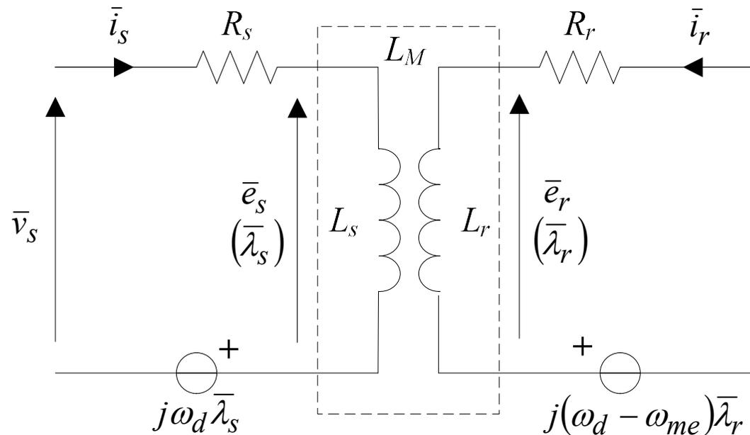
E' facile da questo dedurre i due circuiti di tipo “scalare” uno valido per le componenti di asse d e l'altro per quello di asse q.
