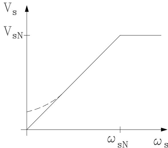
La curva continua si ottiene ponendo  $R_s=0$ , ossia trascurando la caduta di tensione sulla resistenza di statore.
