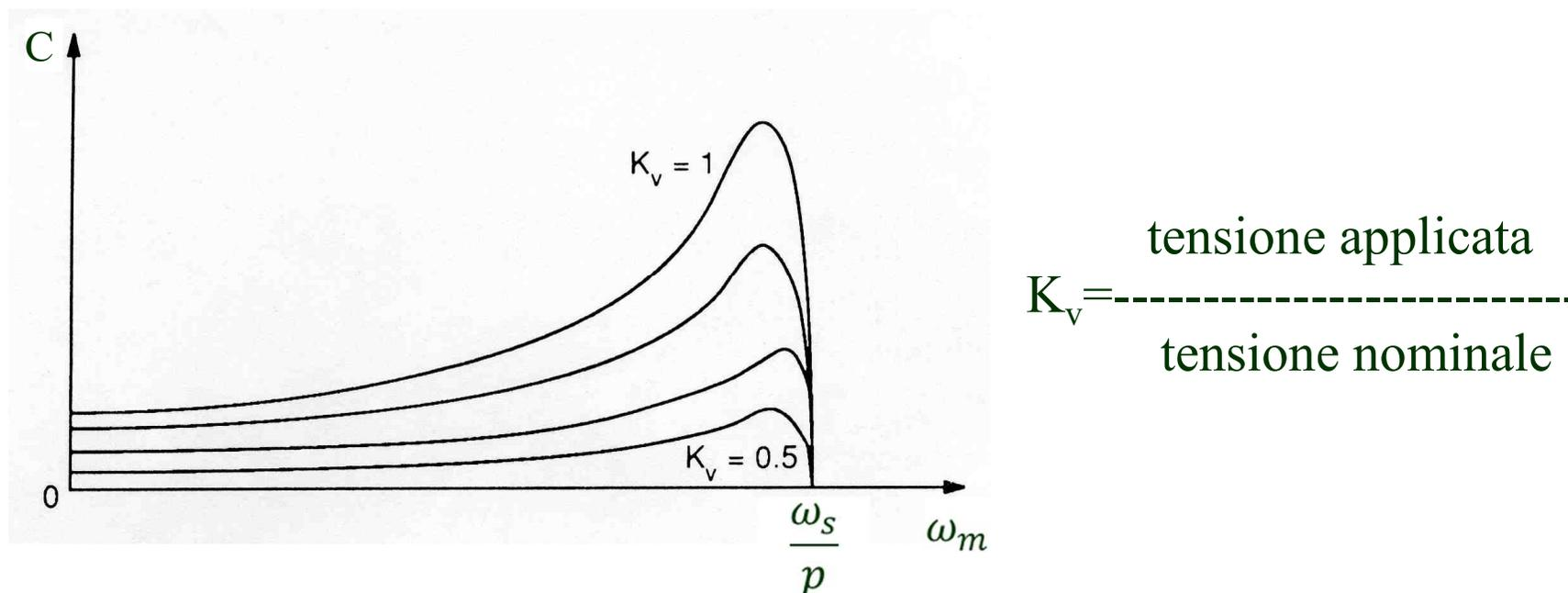
Dal grafico si osserva che al diminuire dell'ampiezza della tensione applicata aumenta la pendenza del tratto stabile della caratteristica (cioè aumenta lo scorrimento del punto di funzionamento) di coppia del motore per cui si ha una piccola variazione della velocità meccanica.
