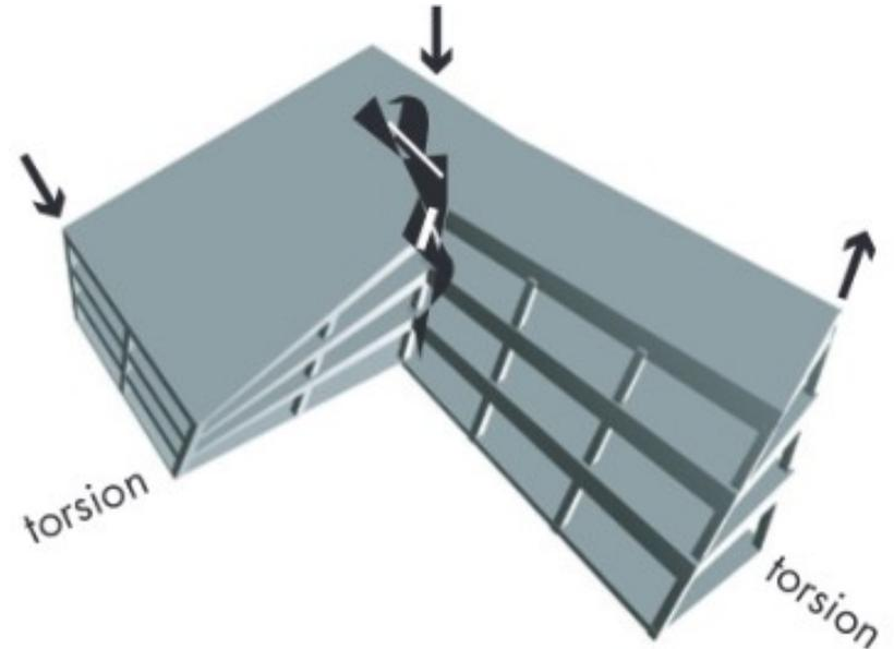
La torsione si manifesta - a livello di edificio - soprattutto nelle strutture **irregolari**
