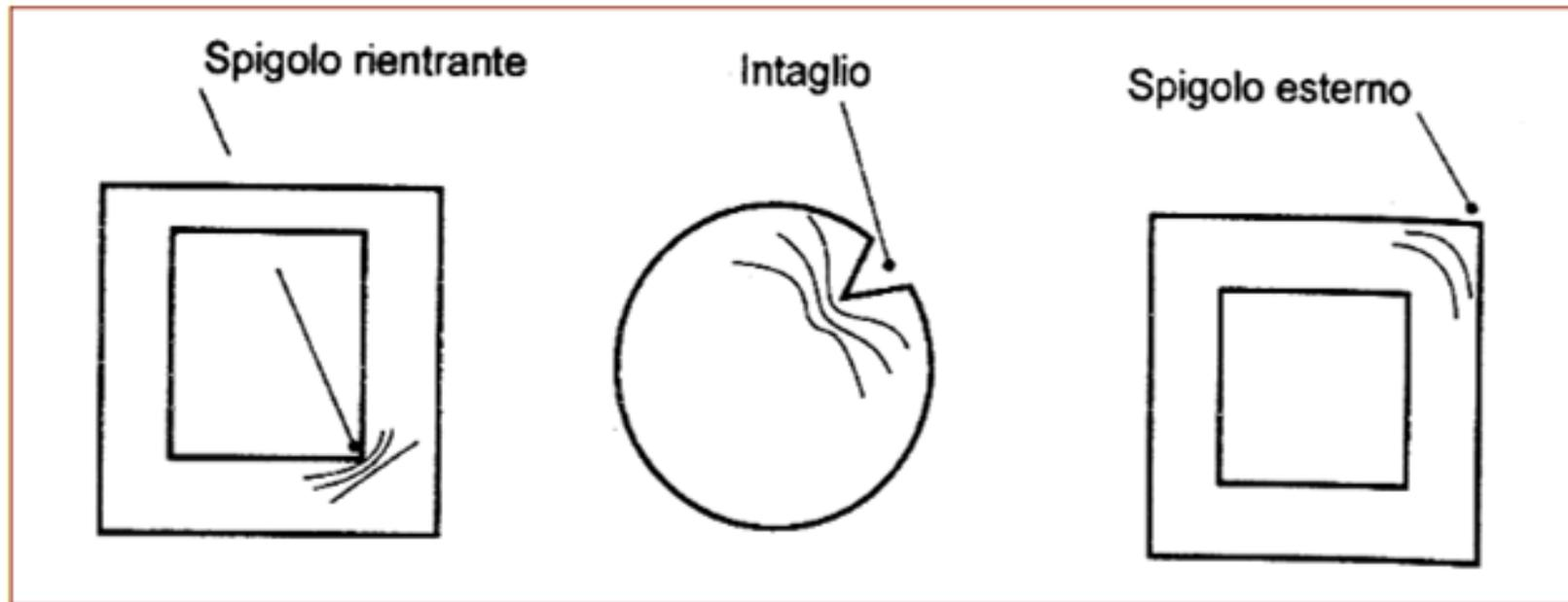
Per evitare concentrazioni di tensioni elevate o spreco del materiali gli spigoli vengono arrotondati.
