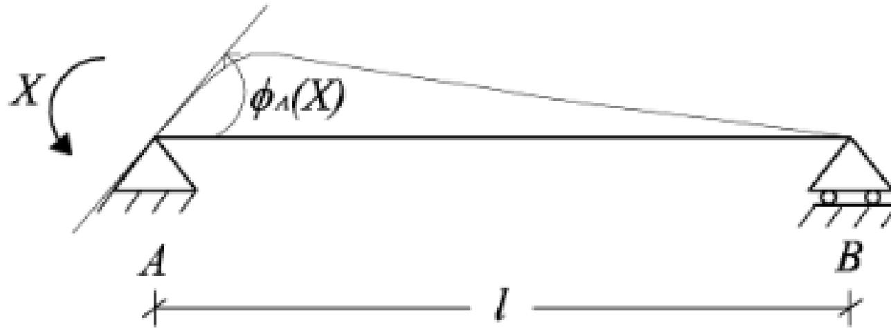
Perché questo avvenga è necessario che la rotazione totale nel punto  $A$ , somma per sovrapposizione degli effetti delle rotazioni dovute rispettivamente alla densità di carico  $\varphi_A(q)$ , ed all'incognita iperstatica  $\varphi_A(X)$ , sia zero. Analiticamente questa equazione si esprime con un'equazione detta “di compatibilità cinematica”:
