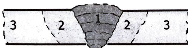
Figura 1.18 Rappresentazione schematica di una zona saldata.
