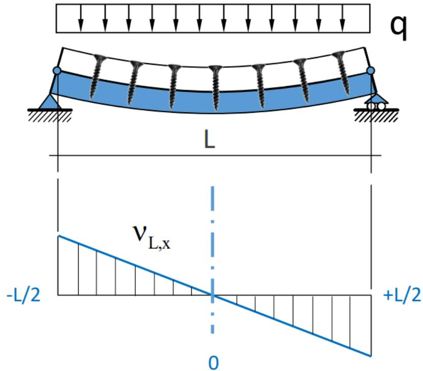
La connessione deve resistere ad un taglio longitudinale  $v_L$  per unità di lunghezza, detto *sforzo di scorrimento*
