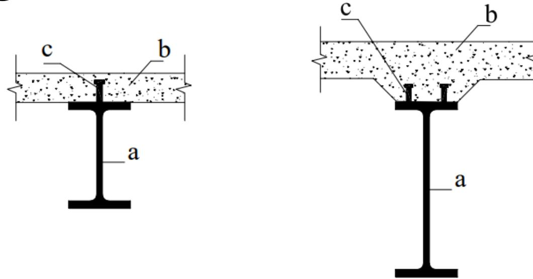
La rigidezza e resistenza del sistema composto è fortemente dipendente dalle caratteristiche della connessione
