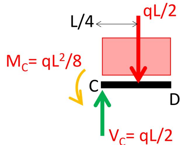
Gli effetti del carico  $q$  si trasferiscono alla restante struttura nella sezione C di attacco:
