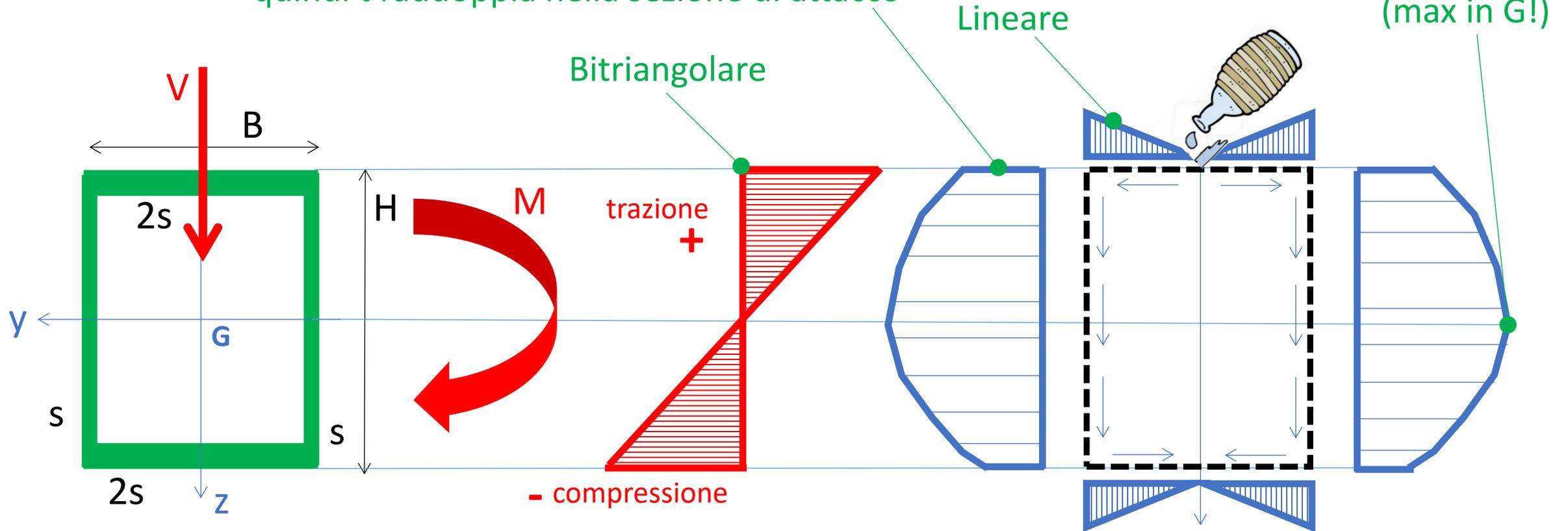
Tensioni  $\sigma$  dovute a  $M$
