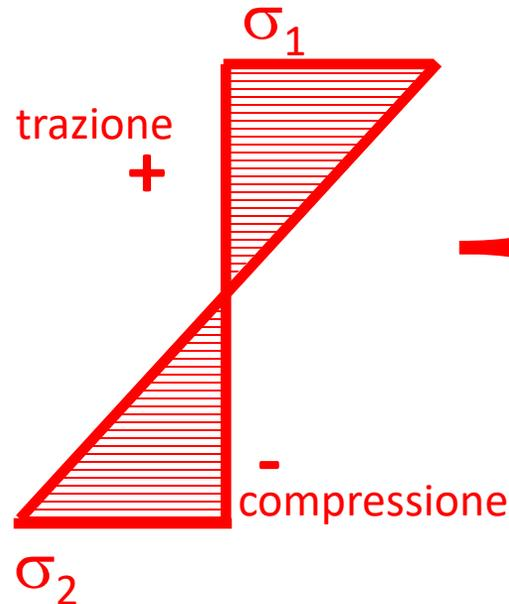
**TESIONI NORMALI  $\sigma$  DOVUTE A M**
