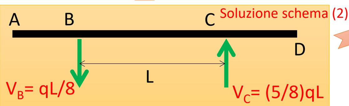
Appurato che  $H_B = 0$ , le reazioni vincolari compressive in B e C per la struttura assegnata si ottengono come sovrapposizione degli effetti degli schemi (1) e (2):
