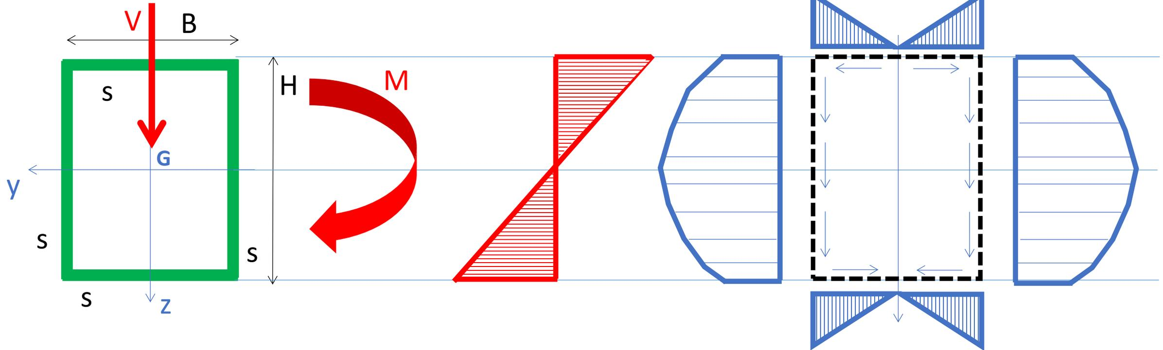
Tensioni  $\sigma$  dovute a  $M$
