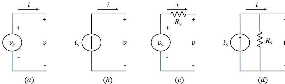
Figura 4: Generatori ideali (a, b) e reali (c, d) di tensione e corrente.
