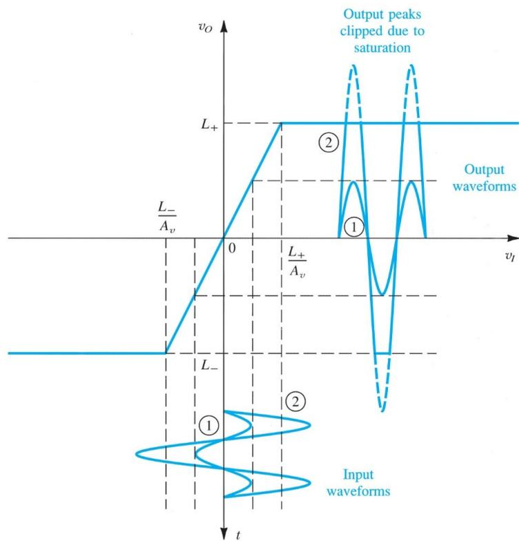
Figura 24: Caratteristica di trasferimento di un amplificatore con regione lineare e saturazione.
