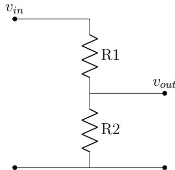
Figura 3: Partitore di tensione
