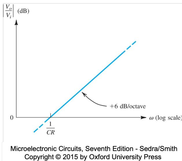
Figura 41: Risposta in frequenza di un derivatore.
