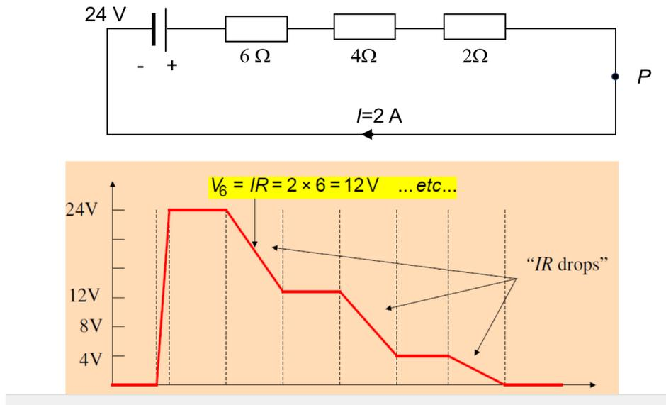
Figura 2: Caduta di potenziale sulle resistenze
