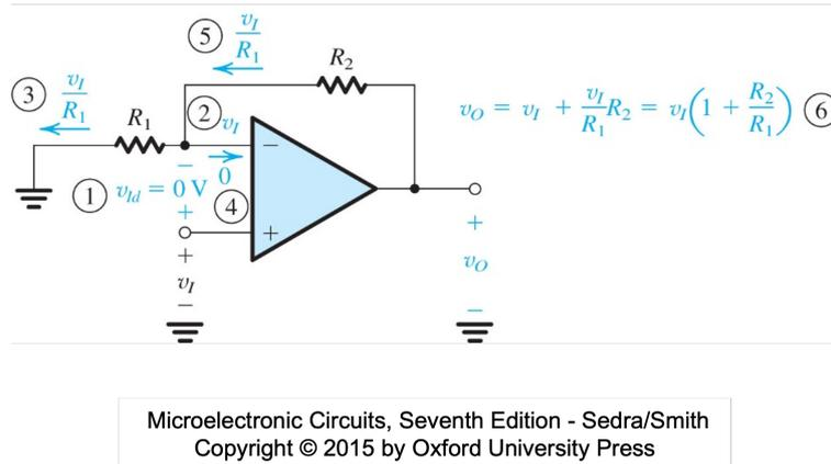
Figura 34: Analisi dell'op amp in configurazione non invertente.
