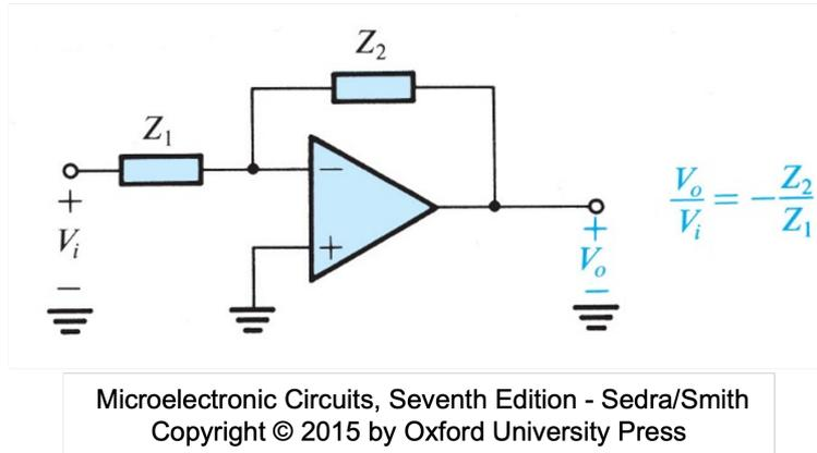
Figura 37: Op amp in configurazione invertente con impedenze.
