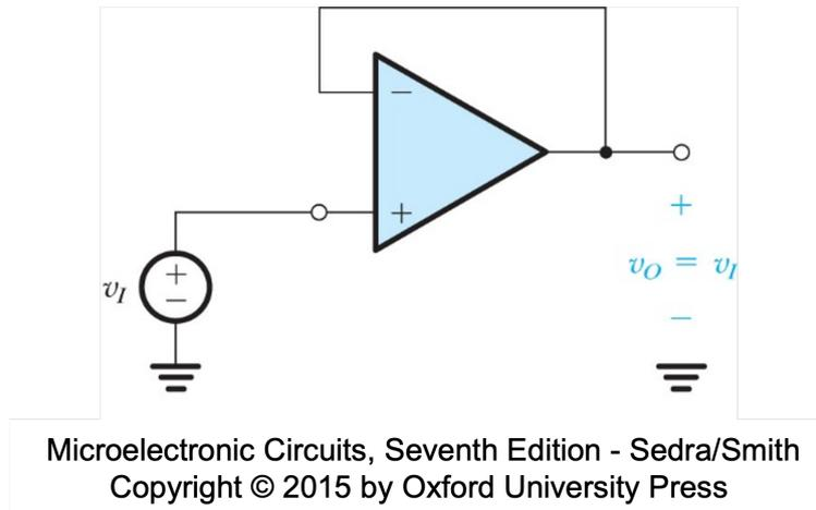
Figura 35: Buffer di tensione a guadagno unitario.
