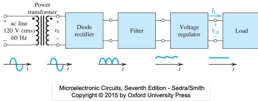
Figura 15: Schema a blocchi di un alimentatore stabilizzato.
