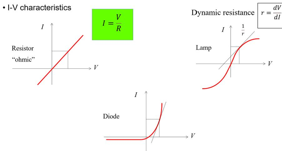
Figura 1: Comportamenti ohmici e non ohmici
