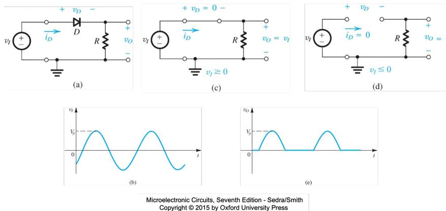
Figura 16: (a) Raddrizzatore a semi-onda. (b) Tensione in ingresso. (c) Diodo in conduzione sostituito da un corto circuito. (d) Diodo in polarizzazione inversa sostituito da un circuito aperto. (e) Tensione in uscita.
