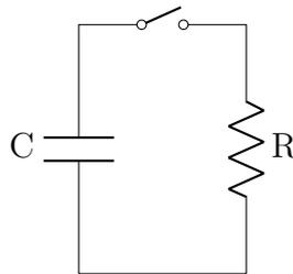
Figura 5: Semplice circuito RC in evoluzione libera (con sola scarica) prima di chiudere il circuito.
