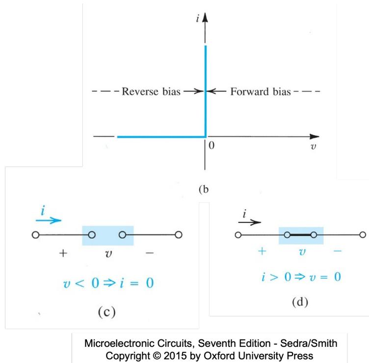
Figura 14: Modello del diodo ideale.
