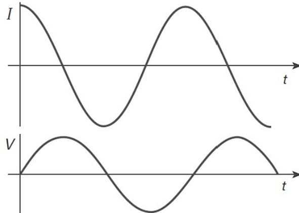
Figura 10: Sfasamento tra tensione ai capi di un condensatore e corrente prodotta dalla capacita' per reazione. Si noti lo sfasamento di  $90^\circ$ .
