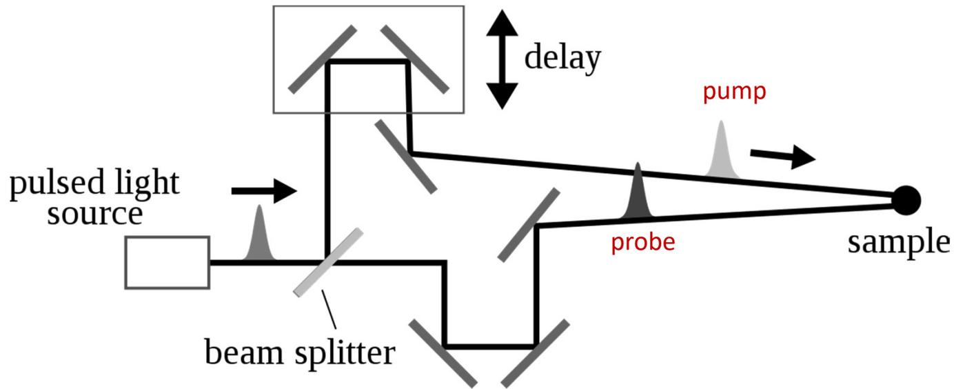
Un fascio di laser pulsato viene splittato in due (pump e probe). Il cammino ottico di uno dei due fasci è regolabile, in modo da poter introdurre un ritardo controllato tra gli impulsi pump e probe che arrivano sul campione. Per laser commerciali, la larghezza temporale degli impulsi forniti dal laser può essere minore di 100 fs; la distanza tra due impulsi successivi può scendere fino a 1ns.
