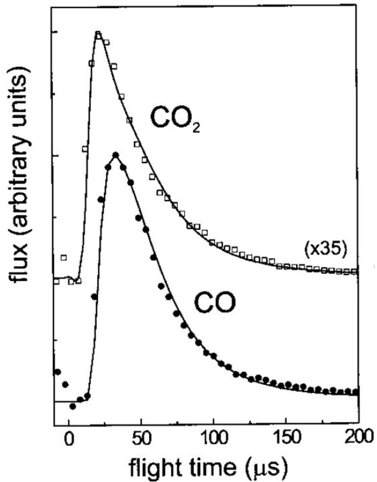
Per verificare se il desorbimento di CO e CO<sub>2</sub> è regolato da elettroni o da fononi, mando due impulsi di fotoni al variare dell'intervallo (delay) tra i due. Se ho sovrapposizione tra gli effetti dei due impulsi, mi aspetto un aumento del desorbimento. Questo aumento c'è per entrambe le specie, ma la dipendenza dal delay è molto diversa...
