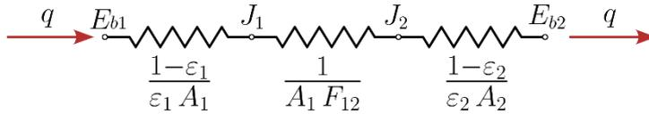
Assumendo che  $A_2$  sia una superficie nera a 0 K, risulta che tutta la radiazione  $q$  incidente in  $A_2$ , e proveniente dalle pareti della scanalatura, verrà irradiata all'esterno. Pertanto per  $A_2$ , essendo  $\varepsilon_2 \equiv 1$  e  $T_2 = 0$  K, risulta  $J_2 \equiv E_{b2} = 0$ , perciò  $\varepsilon \equiv \varepsilon_1$ .
