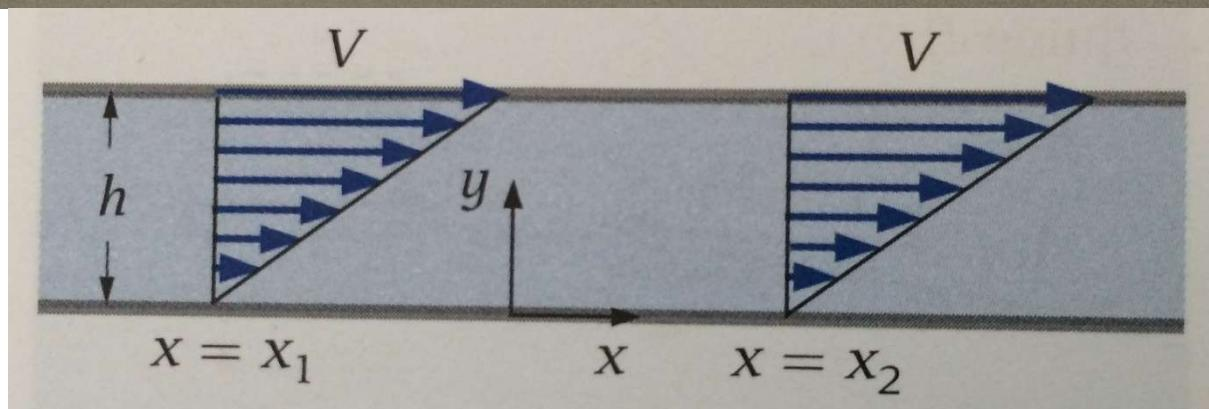
**Fase 2** *Posizione delle ipotesi e delle condizioni al contorno.* Sono state elencate le ipotesi. Le condizioni al contorno derivano dalla condizione di aderenza: per  $y = 0$ ,  $v_x = v_y = 0$ ; per  $y = h$ ,  $v_x = V$ ,  $v_y = 0$ .
