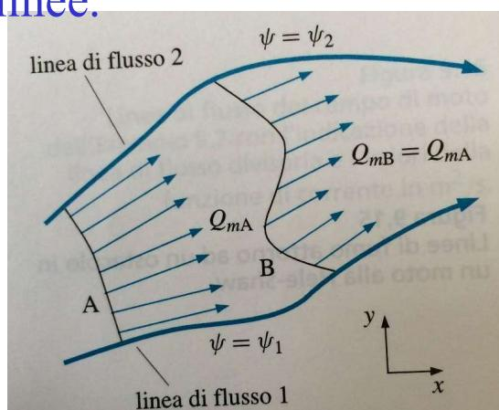
**Esempio 9.6** Stima dell'andamento della velocità dall'esame delle linee di flusso
