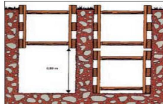
Quando il terreno non rende possibile nemmeno uno scavo di profondità minima, oppure quando si deve operare in siti urbani e occorre evitare qualsiasi depressione del terreno, dopo aver scavato per circa 30 centimetri si infiggono nel terreno le due pareti verticali aventi
