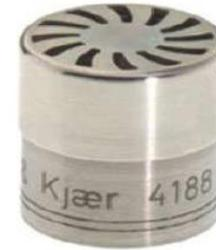
Componente essenziale del Fonometro è il Microfono, cioè il mezzo che noi realmente utilizziamo per intercettare le onde sonore. I Fonometri utilizzano dei Microfoni a Condensatore i quali rispetto ai Microfoni a Velocità risultano avere una maggiore sensibilità, una buona risposta in frequenza e una notevole gamma dinamica, nonostante siano più delicati ed estremamente sensibili alle condizioni ambientali.
