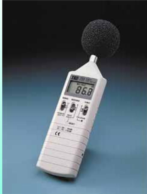
I Fonometri sono apparecchi atti alla misurazione del Rumore come Livello di Pressione Sonora (SPL, Sound Pressure Level), indicando l'energia acustica espressa in forma logaritmica e la cui unità di misura è il decibel (dB).
