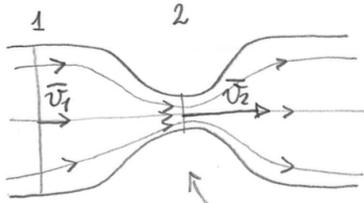
Il tubo di Venturi è un tubo orizzontale con una strozzatura (come in figura). Vogliamo quindi calcolare le velocità e la pressione fuori e dentro la strozzatura. Come prima usiamo l'equazione di Bernoulli. In questo caso le altezze sono uguali quindi
