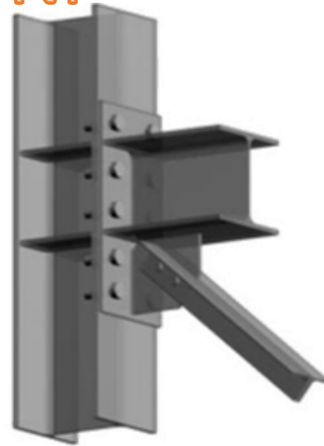
b. Collegamento trave-colonna con controvento
