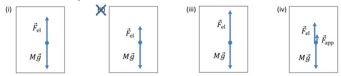
(e) Scrivere la seconda legge di Newton per il blocchetto di massa M nel sistema non inerziale dell'ascensore durante la fase 1 e disegnare il diagramma a corpo libero del blocchetto nel sistema <u>non inerziale</u> dell'ascensore durante la fase 1.
