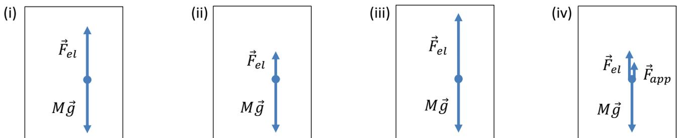
(d) Scrivere la seconda legge di Newton per il blocchetto di massa  $M$  nel sistema non inerziale dell'ascensore durante la fase 1 e disegnare il diagramma a corpo libero del blocchetto nel sistema non inerziale dell'ascensore durante la fase 1.
