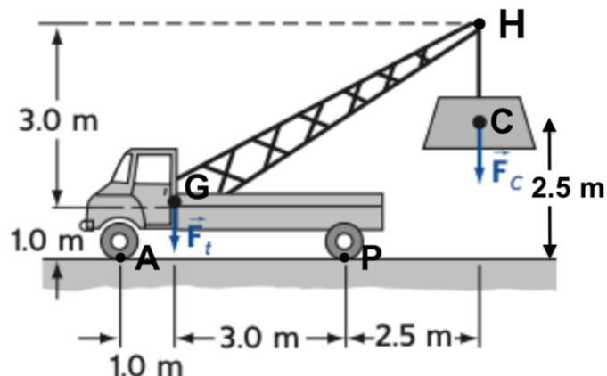
(a) Disegnare sulla figura un sistema assi cartesiani  $x$ - $y$  con origine nel punto  $A$  e calcolare la posizione del centro di massa del sistema autogrù-carico.
