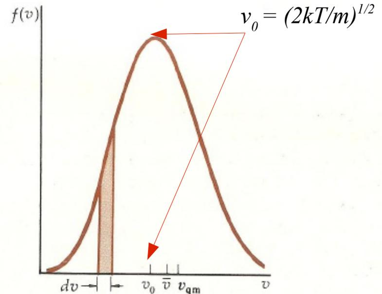
Figura 2. La distribuzione di Maxwell-Boltzmann per le velocità. La frazione di molecole la cui velocità è compresa in un certo intervallo  $dv$  è uguale all'area sotto la curva per quell'intervallo. La velocità  $v_0$  per cui  $f(v)$  è massima è la velocità più probabile. La velocità media  $\bar{v}$  e la velocità quadratica media  $v_{qm}$  differiscono lievemente dalla velocità più probabile.
