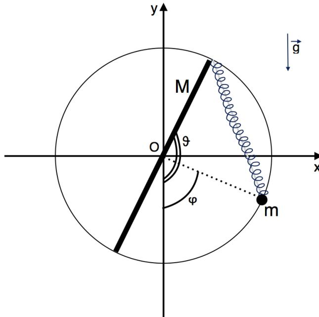
1. Scrivere la Lagrangiana  $L$  del sistema, usando come coordinate libere le coordinate angolari  $\varphi, \theta$  in figura (il momento di inerzia della barra è  $I = \frac{MR^2}{3}$ ) [2pt].
