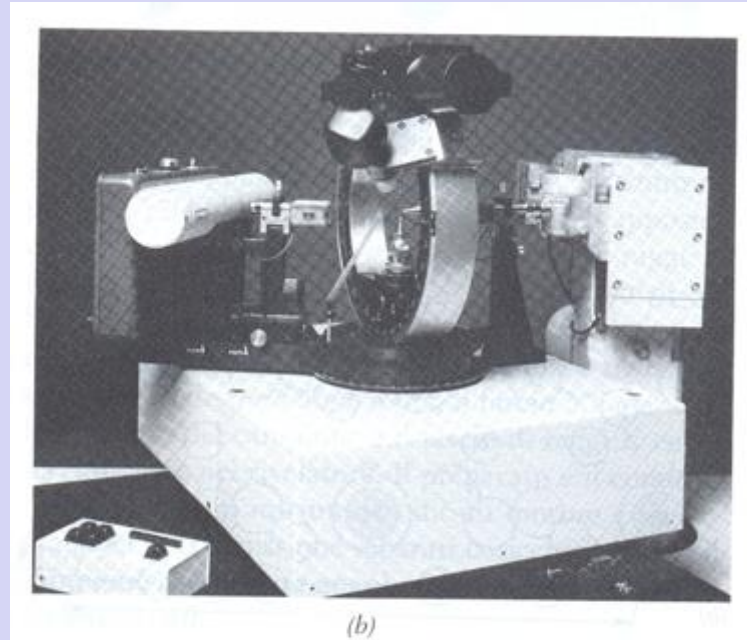
Figura 7.41 (a) Schema del diffrattometro a cristallo singolo modello P4 prodotto dalla Siemens Industrial Automation, Inc. (b) Vista ravvicinata di un goniometro a quattro cerchi per il controllo dell'orientamento di un cristallo singolo (al centro dell'immagine). Sul lato destro è posizionato il tubo a raggi X e sul lato sinistro il contatore di raggi X, del tipo a scintillazione (per concessione di Siemens Industrial Automation, Inc., Madison Wisconsin).
