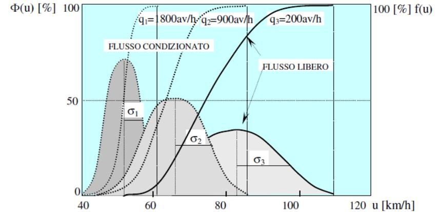
Fig. 7 - Curve qualitative di ddf e cumulative df di rilievi di velocità per portate diverse
