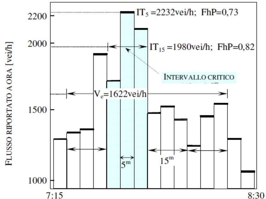
Fig. 1 - Rilievo di flusso in frazioni d'ora di 5<sup>min</sup> (strada urbana, Hcm, 1985)
