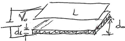
1. Un condensatore piano è formato da due lastre metalliche parallele quadrate di lato  $L=5.3$  cm, separate da una distanza  $d_0=4.3$  mm e caricate ad una differenza di potenziale  $V_0=12000$  V. La rigidità elettrica dell'aria è  $E_{\max,aria}=30$  kV/cm
