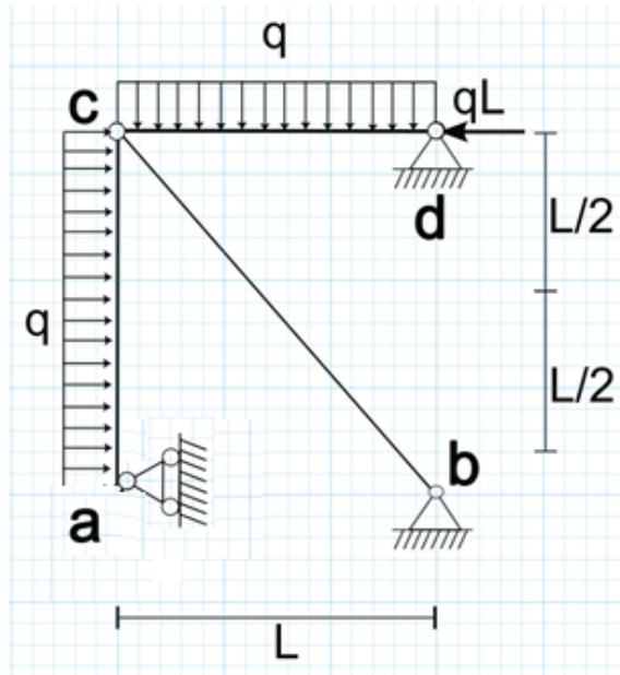
**Quesito n.5 [6/16].** Verificare l'isostaticità della struttura reticolare in figura, calcolarne le reazioni vincolari e le caratteristiche di sollecitazione.
