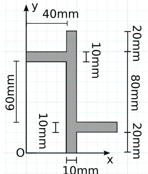
**Quesito n. 2 [4/15].** Determinare il vettore che rende il sistema in figura equilibrato. Misurare la posizione dell'asse centrale rispetto al punto O.
