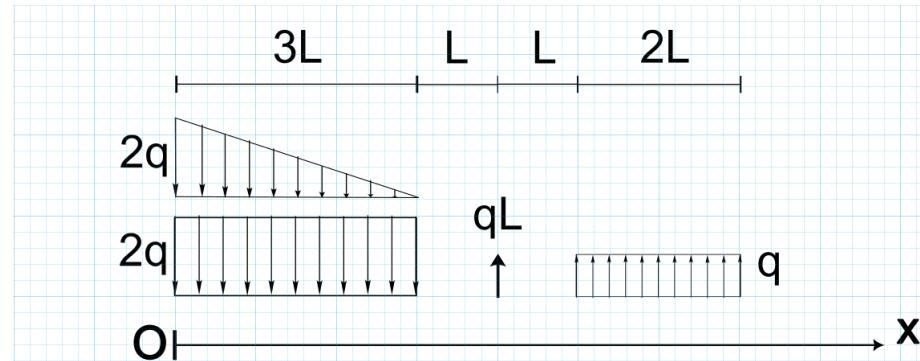
**Quesito n. 3 [3/15].** Determinare per ciascuna struttura la molteplicità dei vincoli e se risulta isostatica, iperstatica o labile. Se presente individuare la posizione del centro di istantanea rotazione.
