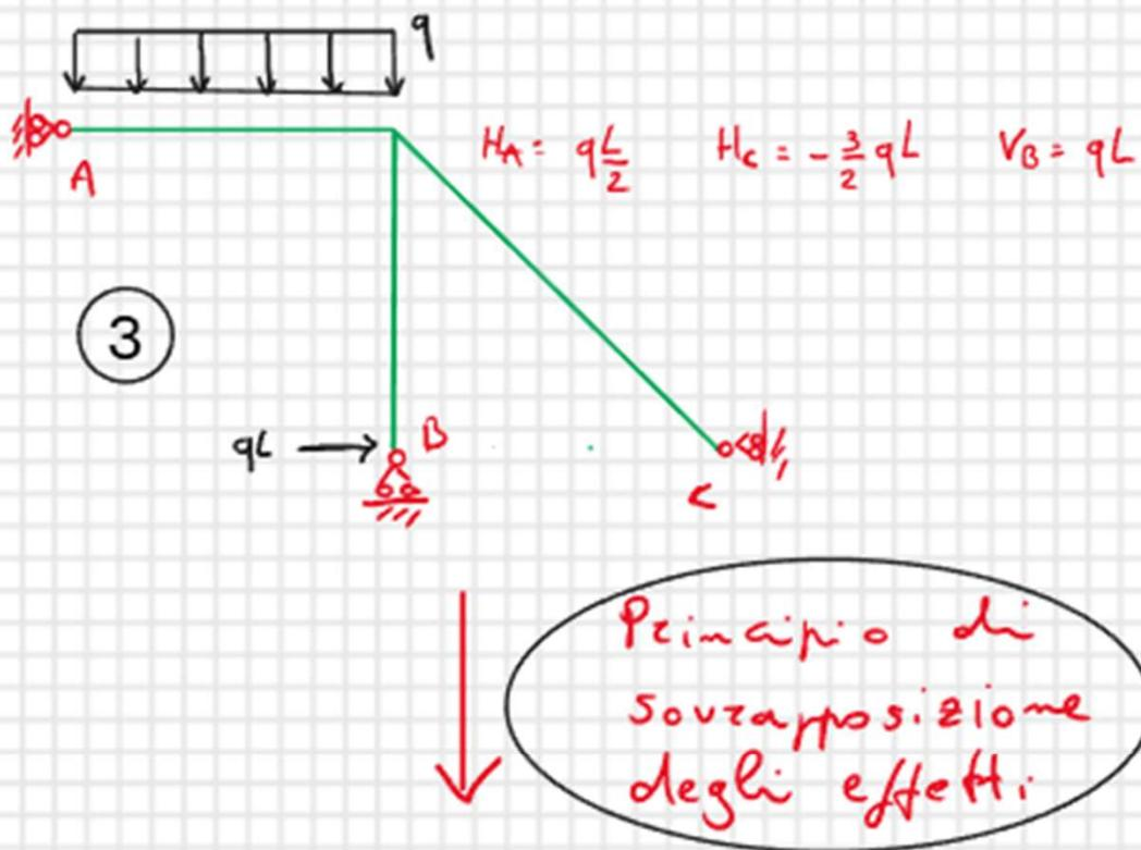
I carichi sulla struttura sono applicati separatamente
