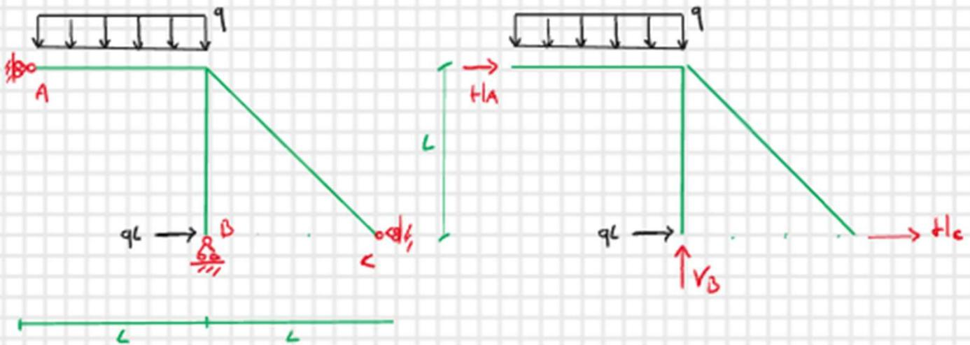
struttura isostatica CR non esiste
