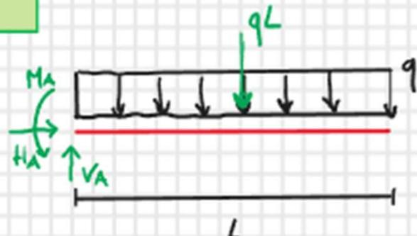
$$1) \quad \theta_k = 0 \quad 2) \quad V_A - qL = 0 \quad 3) \quad M_A - (qL) \cdot \frac{L}{2} = 0 \quad (\text{in A})$$
