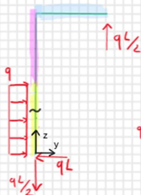
Ruota il conico di 90° per allinearlo agli assi z e y locali, scegli la faccia di normale positiva, gialla.
