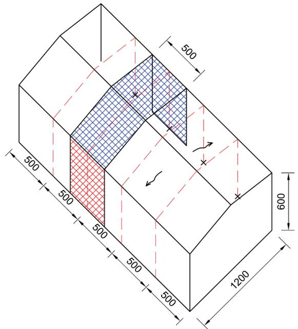
Velocità di riferimento  $V_r$ :Zona Trieste  $\Rightarrow$  Zona 8 $V_{b,0} = 30$  m/s -  $a_0 = 1500$  m -  $k_s = 0.50$  $a_s \sim 0$  m s.l.m.m.  $\Rightarrow a_s < a_0 \Rightarrow c_a = 1$  $\Rightarrow v_b = v_{b,0} c_a = 30 \times 1 = 30$  m/s $T_R = 50$  anni  $\Rightarrow v_r = v_b c_r(T_R) \Rightarrow c_r(T_R=50) = 1$  $v_r = v_b c_r = 30 \times 1 =$  $v_r = 30$  m/s = 108 km/h
