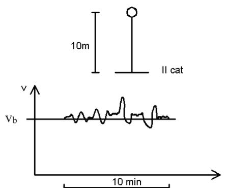
Per ottenere la velocità del vento ad un'altezza diversa, occorre introdurre un coefficiente di profilo  $\alpha_z$  che dipende dalla rugosità del terreno e dall'andamento della sua velocità media con l'altezza (profilo logaritmico).
