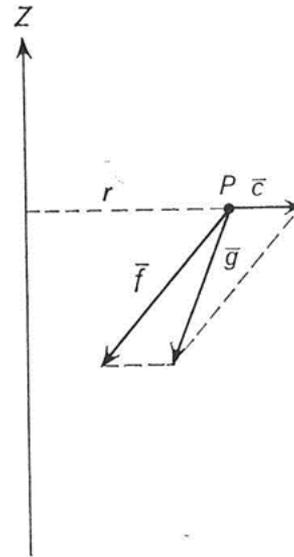
Il vettore gravità  $\bar{g}$  in un punto generico  $P$  è una funzione della posizione del punto, ovvero delle tre coordinate che lo individuano
