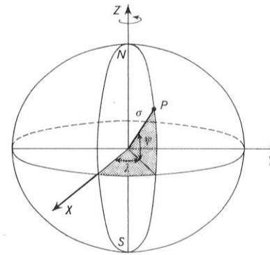
Fig. 7. Coordinate polari geocentriche.
