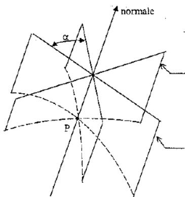
piano che definisce la sezione normale principale con raggio di curvatura in P pari a N
