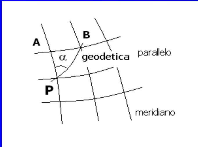
Consideriamo le linee che congiungono due punti sulla superficie di riferimento, la lunghezza della linea compresa fra due punti rappresenta la distanza misurabile fra questi.
