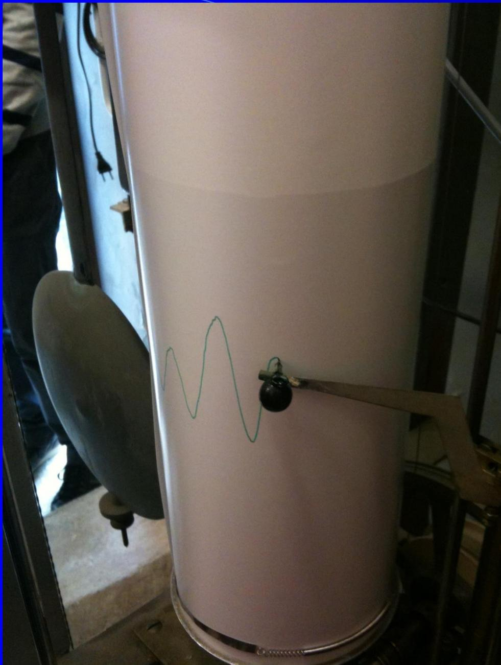
Le **registrazioni analogiche su carta** vengono raccolte a cadenza settimanale in occasione delle calibrazioni periodiche effettuate mediante un idrometro a contatto elettrico con fettuccia metrica. In questo modo sono misurate le altezze del livello rispetto alla piastrina mareografica, per un confronto simultaneo di queste ultime con quelle registrate dagli strumenti.
