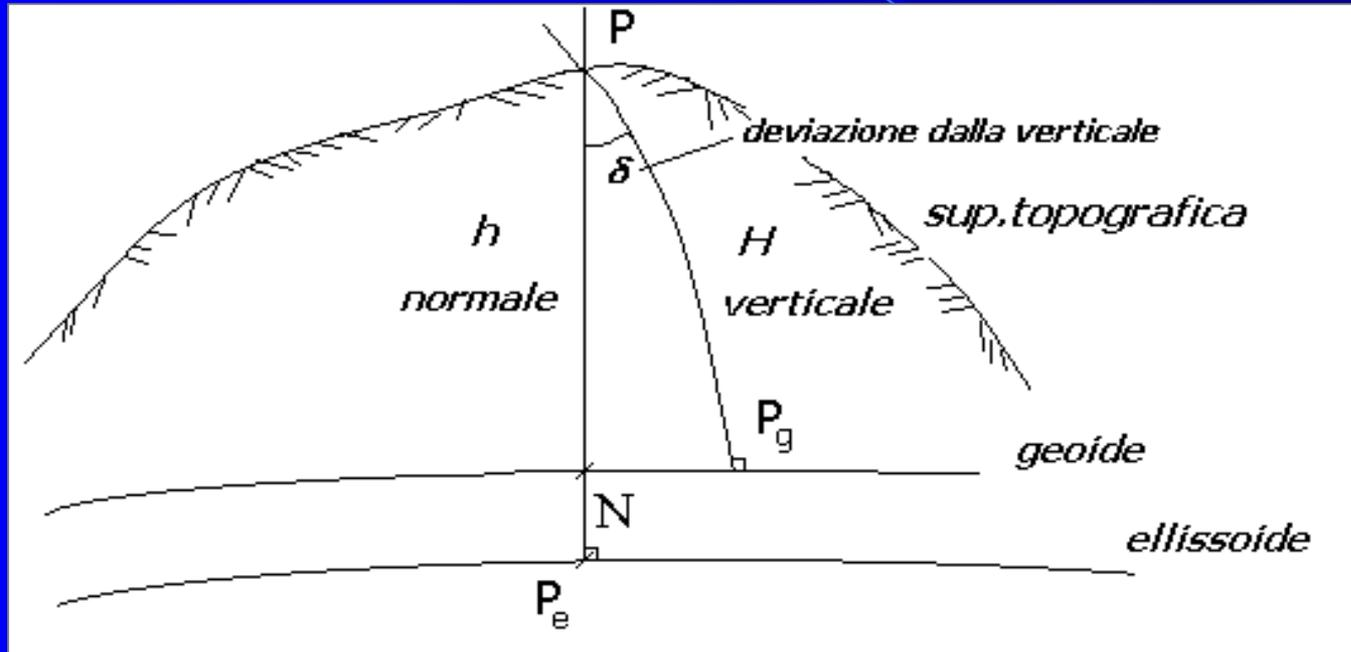
La distanza (data da un tratto di linea di forza) fra un punto  $P$  sulla superficie terrestre ed il punto corrispondente  $P_g$  proiettato sul geoida si chiama **quota** (ortometrica).
