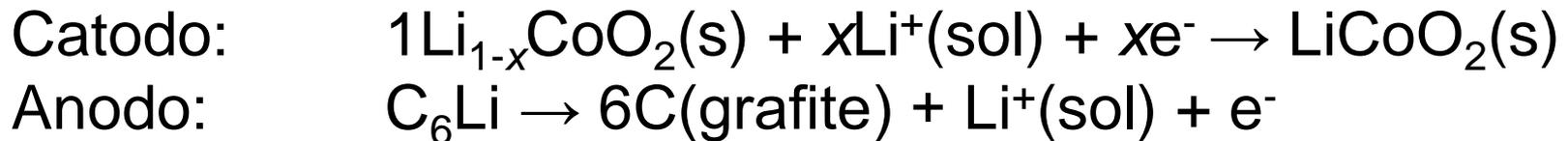
Sia il catodo che l'anodo possono fungere da ospiti per gli ioni  $\text{Li}^+$ , che si possono muovere avanti e indietro tra i due elettrodi durante la scarica e la ricarica. L'elettrolita è un sale di Li (e.g.  $\text{LiPF}_6$ ) in un solvente organico.
