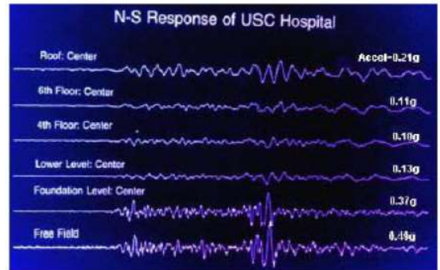
Risposta sperimentale su struttura isolata del terremoto di Northridge
