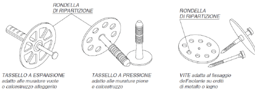
TASSELLI PER IL FISSAGGIO DI PANNELLI ISOLANTI
