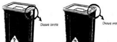
Assemblare correttamente l'apposito imballaggio rigido a perdere, costituito da due parti ad incastro (coperchio e corpo principale), che devono chiudersi perfettamente esercitando una leggera pressione sui bordi esterni. Controllare che il coperchio abbia aderito perfettamente al corpo principale in modo da garantire che il contenitore non si apra durante l'utilizzo.
