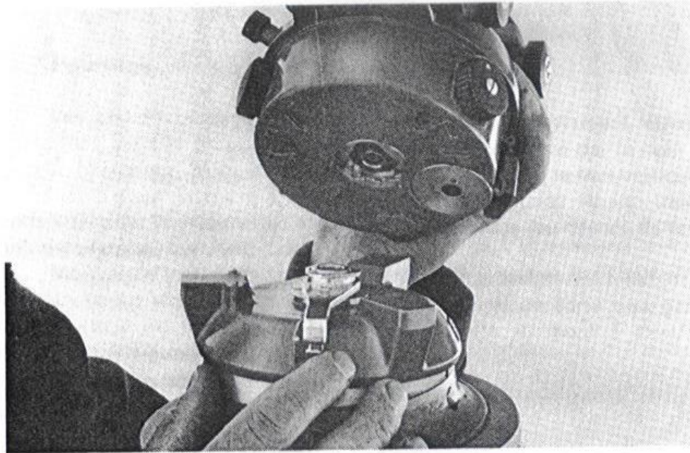
Fig.8 Pose de l'instrument sur le trépied centrant
