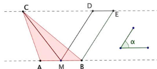
Il quadrilatero MBED è un parallelogramma e, per la Prop. 41, ha area doppia del triangolo  $BMC^\Delta$  (avendo la stessa base e essendo compreso tra le stesse parallele)
