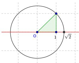
Utilizzando la versione del teorema di Pitagora relativa ad un arbitrario triangolo rettangolo, è possibile vedere che il numero  $\sqrt{n+1}$  è la diagonale di un rettangolo i cui cateti hanno lunghezza  $\sqrt{n}$  e 1: dunque è possibile disegnare (con riga e compasso) un segmento della lunghezza  $\sqrt{n}$  per ogni numero naturale  $n$ .
