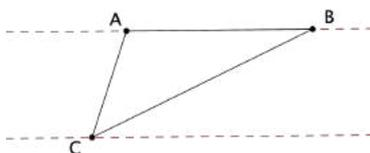
Se un triangolo o un parallelogramma è compresso tra due parallele, la distanza tra le due parallele coincide con l'**altezza** del poligono rispetto ai lati contenuti nelle parallele.
