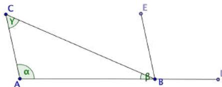
$CB$  risulta trasversale rispetto alle parallele  $AC$  e  $EB$ : per la Prop. 29, l'angolo  $\gamma = \widehat{ACB}$  coincide con l'angolo alterno interno  $\widehat{CBE}$ , che è parte dell'angolo esterno in  $B$ .
