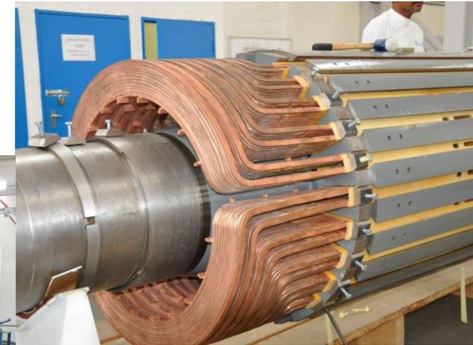
Poli lisci: macchine a 2 o 4 poli quando la forza centrifuga è elevata → diametri elevati ed elevate velocità.
