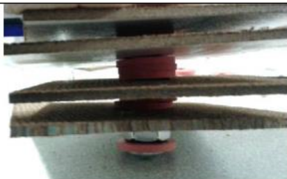
Fig. 10: materiale per i SA: lamelle di faesite grezza, un perno, guarnizioni di stanziatrici di gomma e un golfaro
