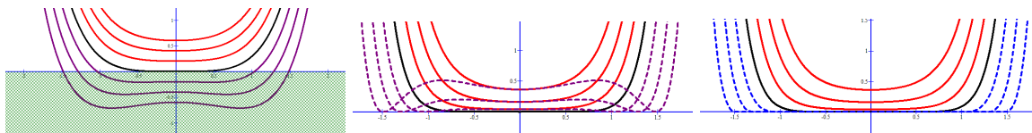
Figura 2: Esempio 3.5. A sinistra: le soluzioni z dell'equazione differenziale (25). In mezzo: un'errata interpretazione delle soluzioni dell'equazione di Bernoulli. A destra: la corretta interpretazione.
