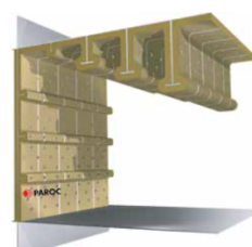
Figura 28- Esempio di isolamento termica e/o tagliafuoco
