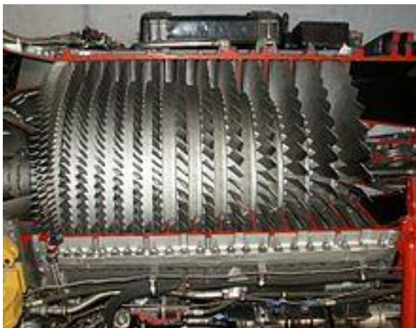
Compressore assiale (macchina termica operatrice dinamica).
