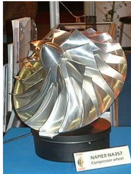
Compressore radiale (macchina termica operatrice dinamica).
