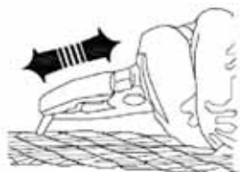
fig. 12 – rimozione di un filo rotto
