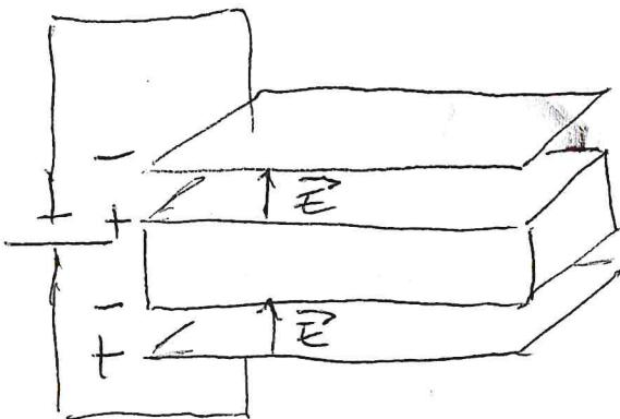
1. In un condensatore a facce piane (rettangolari) e parallele, con lati di dimensioni  $\ell=45.1$  cm e  $p=20.4$  cm poste a distanza  $d=5.00$  mm, mantenuto ad una tensione di  $V=12.0$  V, inseriamo una lamina metallica di spessore  $b=3.00$  mm, esattamente a metà tra le piastre, scorrendo lungo il lato più lungo.
