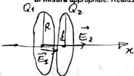
1. Due anelli di raggio  $R=1.0$  cm sono disposti parallelamente uno all'altro a una distanza reciproca pari a  $d=0.5$  cm. I due anelli sono carichi con carica rispettivamente  $Q_1=1.0 \mu C$  e  $Q_2=-0.8 \mu C$ .
