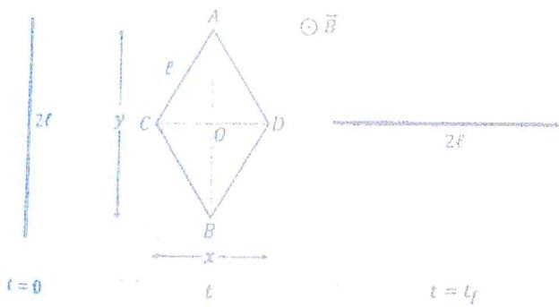
3. Un telaio metallico snodabile è formato da quattro lati equali di lunghezza  $l = 1m$ . Esso si trova immerso all'interno di un campo magnetico di induzione uniforme  $B = 0.5 T$  ortogonale al telaio stesso e uscente (vedi figura). All'istante iniziale, il telaio è completamente chiuso in verticale mentre successivamente la distanza tra gli estremi opposti del telaio viene diminuita linearmente finché esso non richiuse in orizzontale in un tempo complessivo di  $t_f = 3.413s$ .
