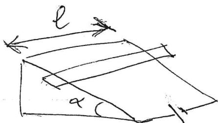
3. Una barretta orizzontale di lunghezza  $l=20.0$  cm, massa  $m=60.0$  g e resistenza  $R=40.0$  mΩ scivola senza attrito su due guide parallele, separate dalla distanza  $l$  ed inclinate di  $\alpha=30.0^\circ$  rispetto al piano orizzontale. Le due guide sono collegate ad un generatore di f.e.m.  $V$ . Il sistema è immerso in un campo magnetico verticale di modulo  $B=0.3$  T.
