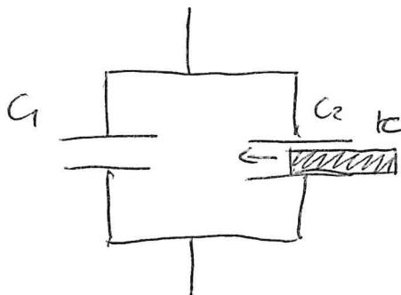
1. Due condensatori di capacità  $C_1 = 250 \text{ pF}$  e  $C_2 = 900 \text{ pF}$  collegati in parallelo sono caricati con una differenza di potenziale di 200V, e quindi isolati. Successivamente viene inserito un dielettrico di costante  $k=80$  fra le armature del condensatore  $C_2$ . Calcolate:
