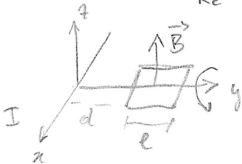
3. Un filo, posizionato lungo l'asse x, è percorso da un corrente  $I=40.2 \text{ A}$  che scorre nel verso delle x positive. Una spira quadrata, di lato  $l=32 \text{ mm}$  e resistenza  $R=13 \text{ m}\Omega$ , ruota attorno all'asse y in senso antiorario, al ritmo di 500 giri al secondo; quando giace nel piano xy la spira occupa un quadrato definito da  $x \in [-l/2, l/2]$  e  $y \in [d, d+l]$ , con  $d=14.2 \text{ cm}$ .
