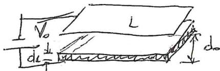
1. Un condensatore piano è formato da due lastre metalliche parallele quadrate di lato  $L=5.3$  cm, separate da una distanza  $d_0=4.3$  mm e caricate ad una differenza di potenziale  $V_0=12000$  V. La rigidità elettrica dell'aria è  $E_{\max, \text{aria}}=30$  kV/cm
