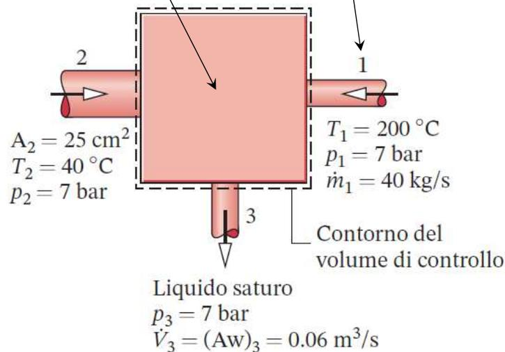
$$\sum \dot{m}_i = \sum \dot{m}_u \quad \text{è condizione necessaria ma non sufficiente: } T \text{ e } p \text{ potrebbero variare nel tempo.}$$
