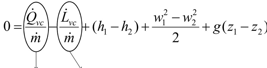
**Calore e lavoro tecnico** specifici (per unità di massa di fluido):  $\frac{W}{\text{kg/s}} = \frac{J}{\text{kg}}$
