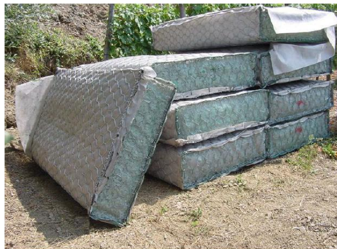
Sistemi di "materassi drenanti"
