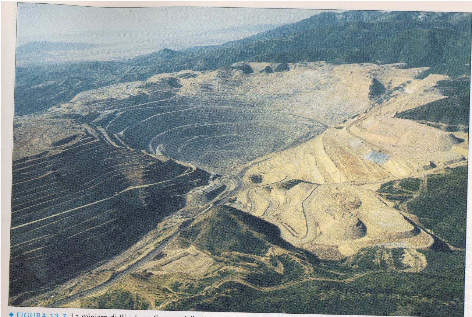
◆ FIGURA 13.7 La miniera di Bingham Canyon della Kennecott Corporation, situata a sud di Salt Lake City, Utah, è la più grande miniera a cielo aperto del mondo ed il più grande scavo artificiale. Nel 2002, lo scavo era profondo oltre 800 metri e largo all'incirca 4 chilometri.
