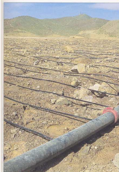
♦ FIGURA 13.30 Sistema di tubature per l'irrorazione del cianuro sul cumulo di lisciviazione. La concentrazione di cianuro è di 200 parti per milione, e la soluzione è mantenuta altamente alcalina per evitare la formazione di gas di cianuro.
